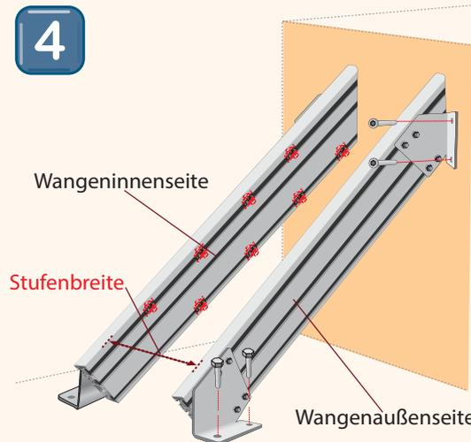
Die in Schritt 3 vormontierten Winkel mit den Schrauben wie in Abb. in die Profilwange einstecken und fixieren.
