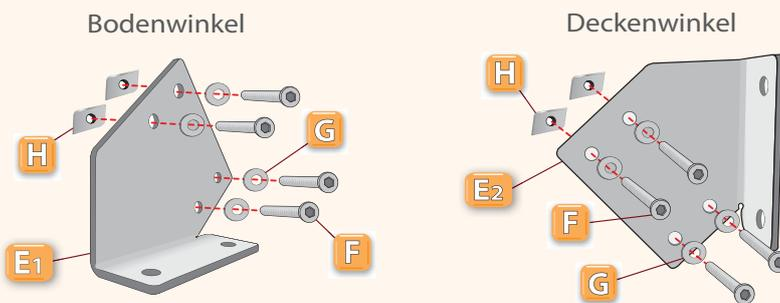
Boden-/Deckenwinkel (E) mit Inbusschraube M10x20 (F), U-Scheibe R11 (G) und Gewindeplatte M10 (H) vormontieren. Fertigungsbedingt können die Befestigungslöcher durch die Feuerverzinkung verengt sein. → Löcher bauseits nachbohren!
