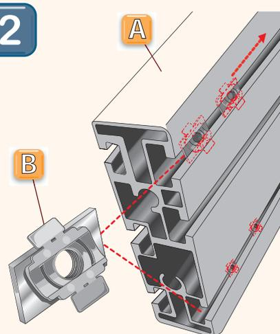
Vormontage der Wangen: Gewindeplatte M8 (B) mit Kunststoff-Clip in die obere + untere Nut der Profilwangen (A) einfädeln (pro Stufe 2x Gewindeplatten für Wangeninnenseite). **Wichtig: Diese Montage muss vor dem Verschrauben der Befestigungswinkel erfolgen.**
