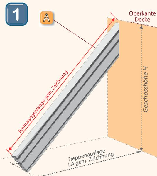
Genau Alu-Profilwangen-Länge (A) entsprechend der Zeichnung auf der Rückseite ermitteln und Wangenfuß kürzen. Entscheidend für die Wangenlänge ist die tatsächliche Geschosshöhe.
