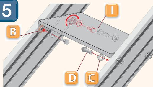
Die Stufen (I) zwischen den Wangen mit den Sechskantschrauben M8x16 (D) und Unterlegscheiben Ø8,4 (C) bereits im ersten Schritt installierten Gewindeplatten M8 (B) leicht fixieren.
