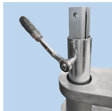
Das Standrohr mit Hilfe eines Verbinders verlängert.
